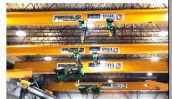
Wie Einflüsse der Krane, eingebetteten jeweils vier Seilzüge von Typ SH 43 und die Krane von Typ ST 51, sorgen dafür, dass die Lasten sicher und stabil transportiert werden können.
