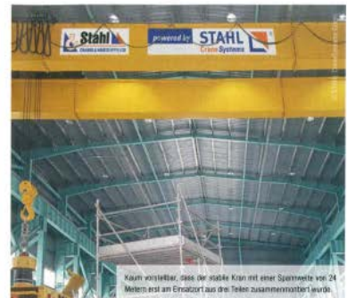
Kann vorstellen, dass der stabile Kran mit einer Spannweite von 24 Metern erst am Einsatzort aus drei Teilen zusammensortiert wurde.
