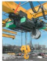
➋ Durch eine waagrecht stehende Ausgichterolle (Pfeil) hat der Greifer-Selbstzug eine geringe Bauhöhe.
