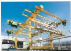
➍ Zwei Errichten von Test-Deichen entwickelte Stahl CraneSystems für die Forschungsinstitut Delftware einen Portalkran, der sich über die gesamte Länge des Beckens verfahren lässt.
