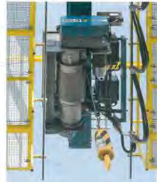
Entsprechend den besonderen Vorgaben des Betreibers wurde eine Spezialseiltrommel gefertigt, die in der Mitte einen Durchmesser von 457 mm hat
