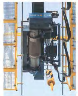
图3 STAHL CraneSystems 专门定制了钢丝绳卷筒以满足客户的技术要求
