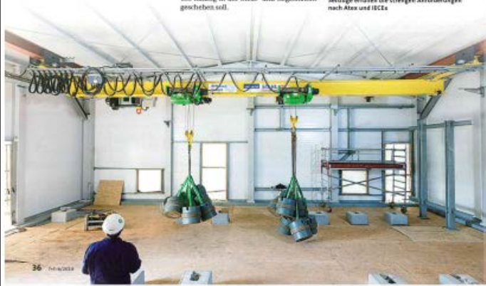
01 Die für den Tandembetrieb ausgelegten Seilzüge erfüllen die strengen Anforderungen nach ATEX und IECEx
