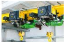
01 Die für den Tandembetrieb ausgelegten Seilzüge erfüllen die strengen Anforderungen nach ATEX und IECEx
