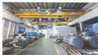
« Um die immer größeren und schwereren Motoren transportieren zu können, übersteigerte die Krananlage von 2 x 16 auf 2 x 32 Tonnen Traglastkapazität auf
