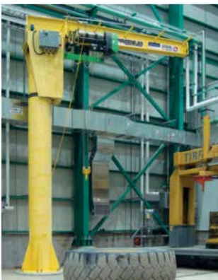
Reifenwechsel per Schwenkkrane. Der eingesetzte Elektroszug SH hebt bis zu zehn Tonnen.
