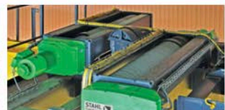
Die Seile der gekoppelten AS 7-Züge laufen über eine Umlenkrolle, sodass eine verschleißarme Hubbewegung ohne Hakenwanderung möglich ist.
