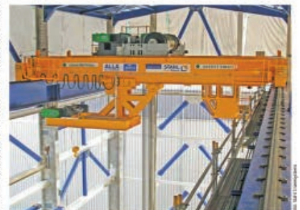
Bild 2: ALLA-Spezialkran mit Stahl-Crane-System-Technik: Die Laufkatze ist mit einer 180-t-Winde von Typ SW und einer 25-t-Seilzug SH bestückt. Unter der Kranbrücke befindet sich ein beweglicher Ausleger mit einem zusätzlichen 12,5-t-Hilfseilzug.
