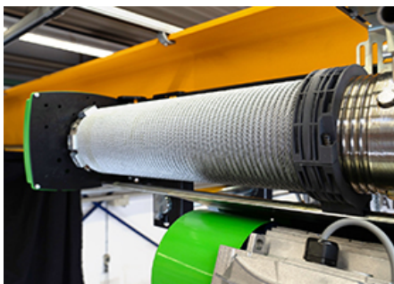
Imagem 3. A guia de cabo melhorada protege o cabo, evita que seja enrolado em excesso, reduz os requisitos de manutenção graças à instalação simples e garante fiabilidade e segurança.
