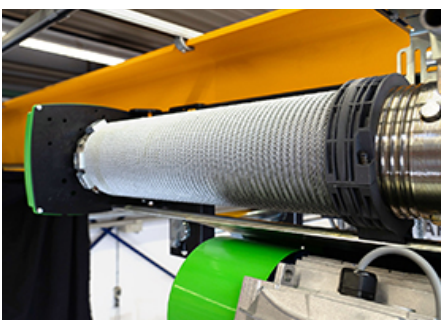
Immagine 3. Il guida fune migliorato protegge la fune, ne impedisce l'accavallamento e riduce le esigenze di manutenzione grazie alla semplicità di installazione, garantendo affidabilità e sicurezza.
