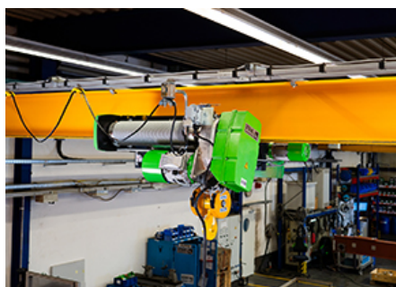
Immagine 5. Il paranco a fune SxD in una applicazione industriale.
