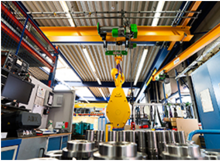
Image 4. Les ponts roulants monopoutre de la gamme CraneKit de STAHL CraneSystems, équipés des nouvelles séries de palans à câble SXD et SXF, facilitent le transport efficace des composants.
