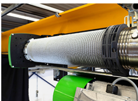
Image 3. Le guide-câble amélioré protège le câble, empêche son enroulement excessif, réduit les besoins d'entretien grâce à une installation simple et garantit fiabilité et sécurité.
