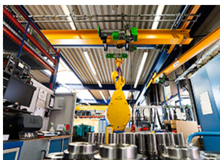
Imagen 4. Los puentes grúas monorrailes equipados con nuestros CraneKit by STAHL CraneSystems y nuestra nueva serie de polipastos de cable SXD y SXF, facilitan el transporte aéreo de componentes de forma eficiente y segura.
