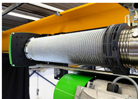
Imagen 3. El nuevo robusto sistema de guía de cable proporciona una protección extra al cable de elevación y a su correcto enrollamiento en el tambor, de fácil mantenimiento por su sencilla instalación.
