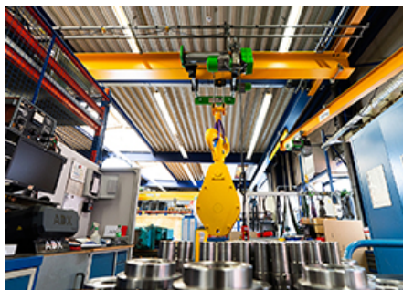
Bild 4. Einträgerbrückenkran aus dem CraneKit von STAHL CraneSystems mit den neuen Seilzug-Serien SXD und SXF ermöglichen den effizienten Transport von Bauteilen.
