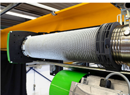
Bild 3. Die verbesserte Seilführung schützt das Seil, verhindert Überwicklung, reduziert Wartungsaufwand durch einfache Montage und sorgt für Zuverlässigkeit und Sicherheit.
