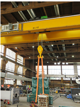
Bild 6 + 7 Abnahmeprüfung mit Prüfgewichten
