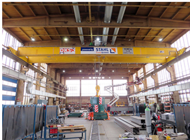
Bild 6 + 7 Abnahmeprüfung mit Prüfgewichten
