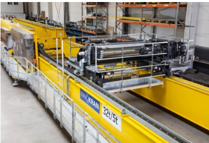
Die Stromzuführung für die 32-t-Winde SHWF 8 und das 5-t-Hilfshubwerk laufen jeweils geschützt in einer Energiekette.
