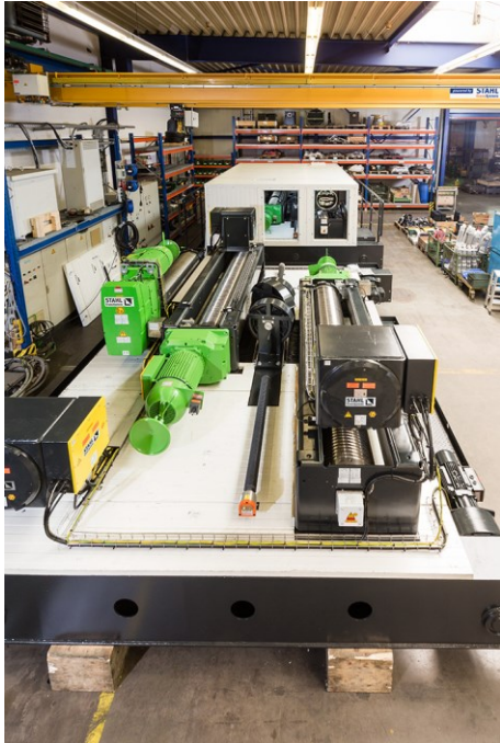
图 3: 副钩 (SH 钢丝绳葫芦，左)，主钩 (AS 7 钢丝绳双葫芦，中右)，控制和 加热系统在其中一台双梁小车上。
