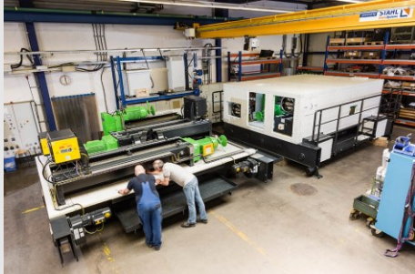
图 1: 在德国金策尔绍的 STAHL CraneSystems 工厂内生产葫芦，小车 和外壳。左侧的 LNG 钢丝绳葫芦还未安 装外壳，右侧的已经安装在白色外壳 内。
