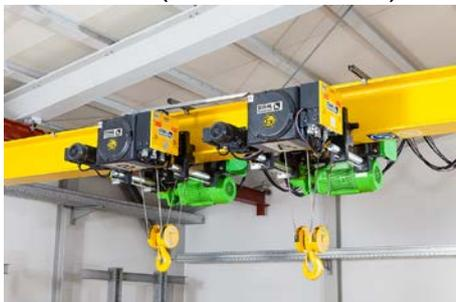
Explosionsschutzgeschützte Seilzüge von STAHL CraneSystems erfüllen die strengen Anforderungen nach ATEX und IECEx.
