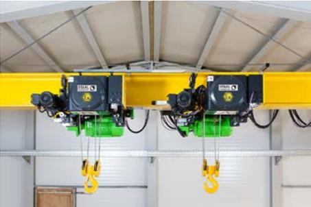
Explosionsschutzgeschützte Elektroseilzüge vom Typ SH 40 ex, ausgelegt für den Tandembetrieb.
