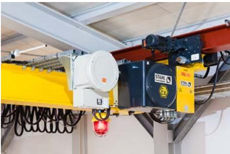
... sowie die Kransteuerung und den Funkempfänger mit druckfester Kapselung.
