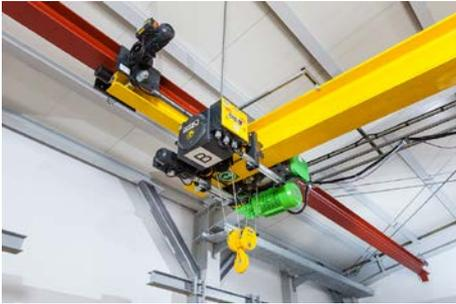
STAHL CraneSystems lieferte die gesamte Krantechnik: Explosionsgeschützte Seilzüge...
