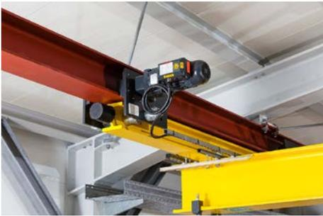
...Hängekrankopfträger mit explosionsgeschützten Fahrmotoren ...
