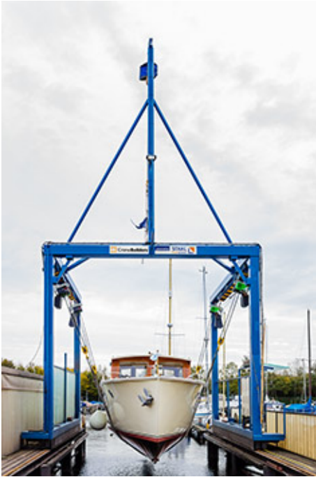
图 3: 额外的环链葫芦装在起重机顶部，用于固定帆船的桅杆。
