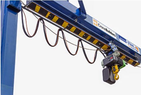
图 5: 4 台葫芦中的 2 台带有小车，因此吊钩间的距离能够按照船的不同尺寸调节。
