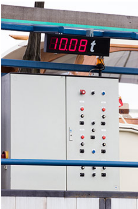
图 6: 大尺寸的显示器一直显示着总负载量。当遥控器失效时，同样经过升级的控制器上，有开关可以控制。
