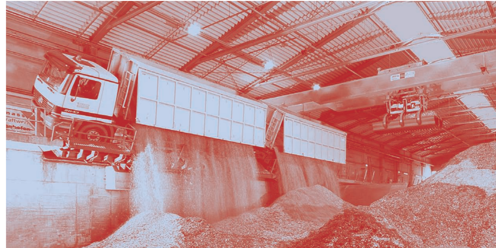
Automatikkrane für Biomasse-Heizkraftwerk
