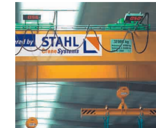
Avec grand totaliseur des charges à quatre chiffres pour le contrôle de la charge totale aux deux crochets.
