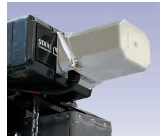
Fins de course du réducteur et fins de course de levage pour arrêt d'urgence du levage en fin de course, dans la position la plus haute ou la plus basse du crochet, et arrêt du service en position haute du crochet.
